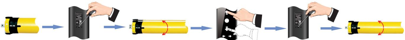
Uveďte výrobek do polohy, kterou chcete změnit > stiskněte programovací tlačítko na zadní straně vysílače > motor udělá jeden krok > nastavte požadovanou polohu pohybem prostředního tlačítka nahoru nebo dolů > stiskněte ještě jednou programovací tlačítko na zadní straně vysílače > motor udělá jeden krok.
