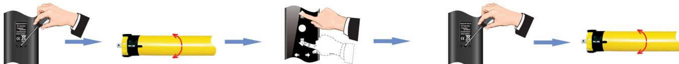
Stiskněte programovací tlačítko na zadní straně vysílače > motor udělá jeden krok > nastavte výrobek do požadované polohy > pro nastavení horní polohy používat výhradně tlačítko ↑ nebo STOP.
